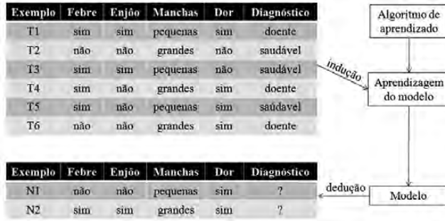
Figura 18.1: Diagrama do processo de indução de um classificador e sua utilização na dedução de novos exemplos.
