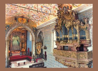
Faces visível e invisível de uma complexa máquina que a talha cobre: canarias de metal e de madeira dispostas através de mecânicos jogos que hoje o ventilador eléctrico (outrora o fole manual) faz soar (vista do órgão no contexto da capela; tubos verticais com orelhas e tubo horizontal exibindo o tampão de afinação; canaria de metal e em madeira).
