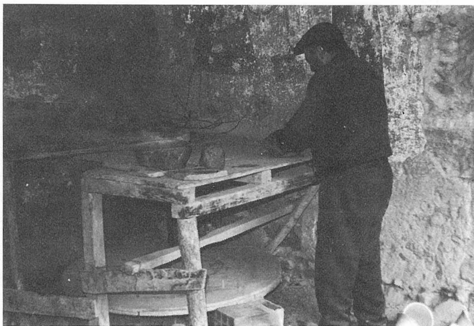
Fig. 11 — Formação da péla ou bola , sobre a arquina ou adoquina da roda-de-oleiro
