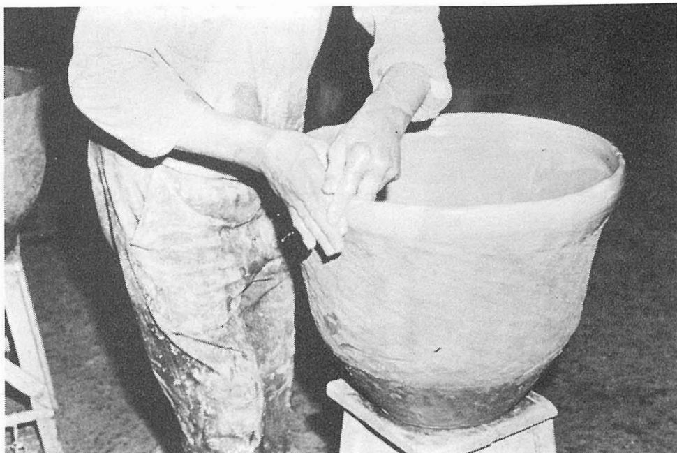
Fig. 21 — O oleiro alisa o barro com as mãos molhadas, enquanto aperfeiçoa a forma da peça
