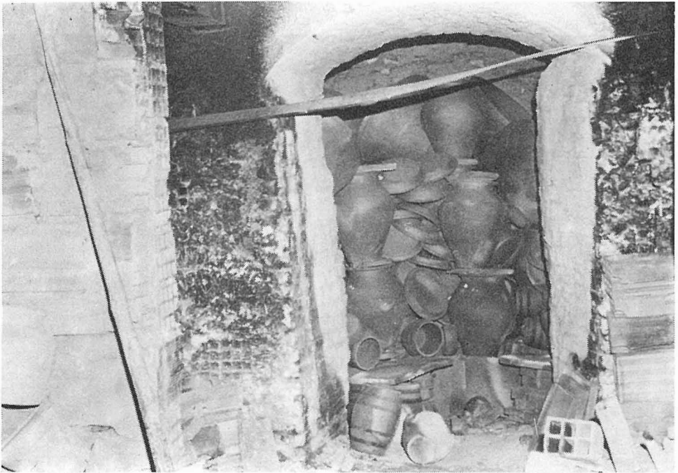
Fig. 30 — Abertura da caldeira mostrando a louça de barro depois de cozida, pronta para desenformar
