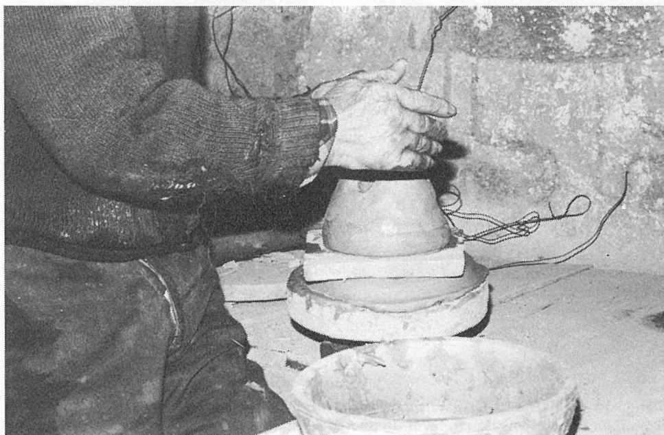
Fig. 12 — O oleiro assenta a péla sobre a cabeça-da-roda
