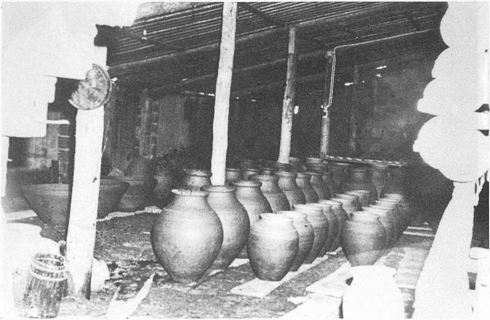
Fig. 25 — Enxugo do barro. Sala para enxugo.
