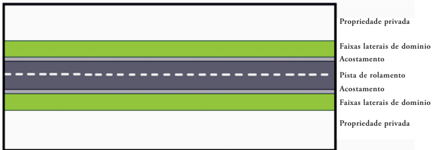
Fig. 2 - Área de domínio da rodovia.
